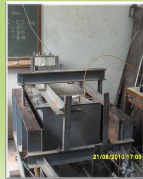
Pullout Test Apparatus
