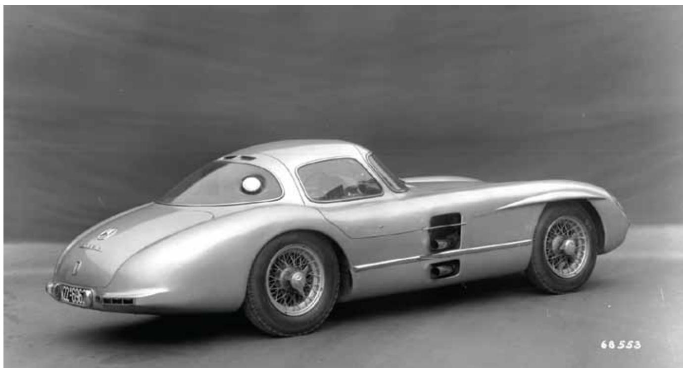
300 SLR Nr. 00007/55 1955 mit Tankeinfüllstutzen durch die Heckscheibe
